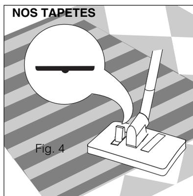
Determinar a posição das cerdas accionando a alavanca presente na boca de aspiração.
