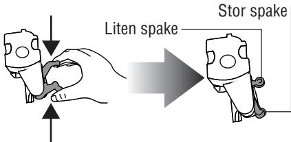
7. Etter at den er satt på plass må man forsikre seg om at de to røde tastene har klikket på plass mot utsiden.
