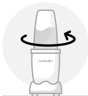
Для разблокировки слегка прижмите и поверните чашу против часовой стрелки.
