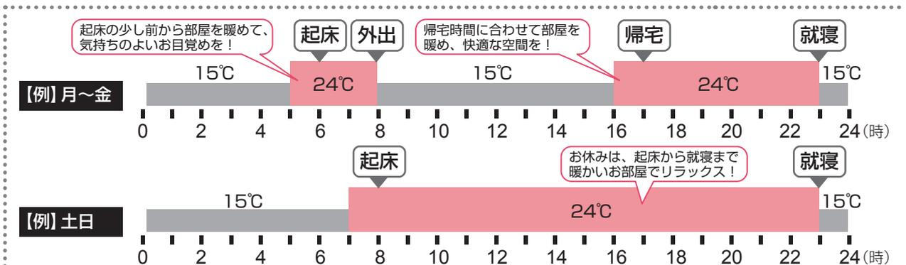
平日は、起床時と夕方帰宅してから就寝まで高めの設定温度(**※**モード)で運転。それ以外の時間帯は低めの設定温度(**●**モード)で運転。
