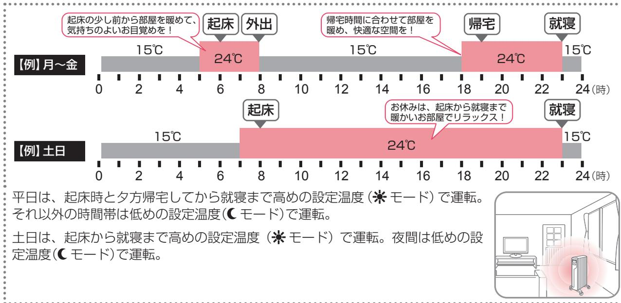
平日は、起床時と夕方帰宅してから就寝まで高めの設定温度（※モード）で運転。それ以外の時間帯は低めの設定温度（●モード）で運転。
