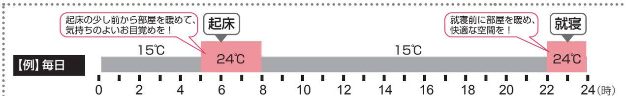
月曜～日曜まで、起床時と就寝前後の時間帯に高めの設定温度(**※**モード)で運転。それ以外の時間帯は低めの設定温度(**●**モード)で運転。
