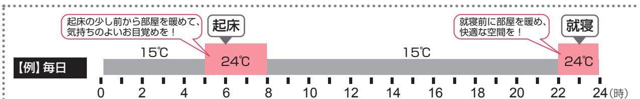
月曜～日曜まで、起床時と就寝前後の時間帯に高めの設定温度(**※**モード)で運転。それ以外の時間帯は低めの設定温度(**☾**モード)で運転。
