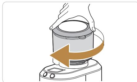
※ホッパーを取り外す際は、ホッパーを反時計回りに回して取り外します。
