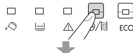
設定されている水硬度レベルに応じたランプが点灯します。
