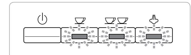
電源を入れると、1杯抽出ランプ、2杯抽出ランプ、スチームランプが同時に点滅します。
