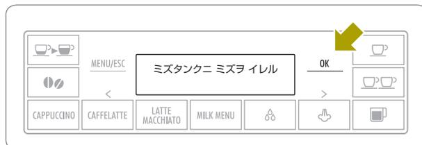
「ジョセツカイ」の表示が消えない場合、何らかの原因で石灰除去が完了していません。その場合は、水だけで石灰の除去を繰り返し行ってください。
