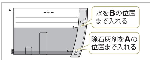
3. トレイと水タンクを取り付け、容量が 1.5L 以上の容器を給湯ノズルの下に置く
