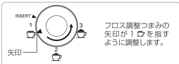
フロス調整つまみの矢印が1 ☺ を指すように調整します。
