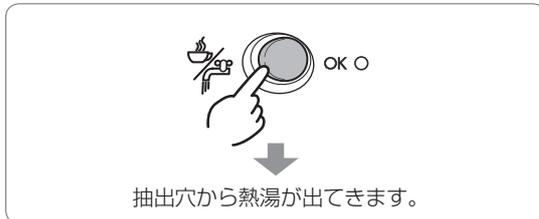
(エスプレッソ抽出) ボタンを押して、初めてお湯を出す際に「ガガガー」という大きなポンプの作動音がしますが、異常ではありませんので続けて給湯してください。マシン内部の配管に水が通り始めると収まります。
