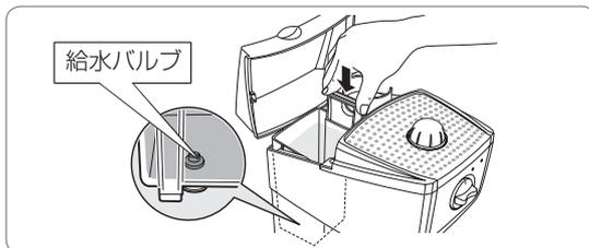
※タンク底の給水バルブが開くように、給水タンクをしっかりと押し下げます。
