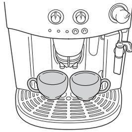
● カップの高さ(7.5cm~10cm)に合わせて、トレイからコーヒー抽出口までの高さを調節できます。
