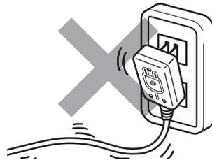
壁のコンセントにガタツキや緩みのある場合は、お近くの電気店に修理をご依頼ください。緩みのあるコンセントを使用すると、電源プラグ(刃)と十分な接触が得られず異常発熱し、火災の原因になります。
