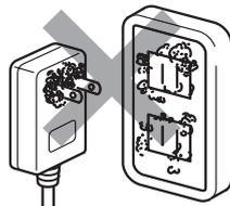
付着したホコリは、掃除機などで定期的に取り除いてください。電源プラグと壁のコンセントの接触面にホコリが付着し、湿気が加わると、トラッキング現象が発生し、火災の原因になります。
