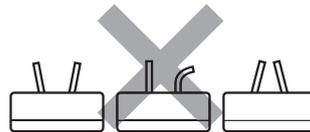
電源プラグ(刃)が変形した場合は、販売店または当社テクニカルセンターにプラグの交換をご依頼ください。曲がった刃は、接触不良時の発熱により、コンセントの刃受を変形させる原因になります。(曲がった刃をペンチなどで手直ししないでください。)
