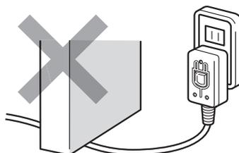
電源コードに重いものを載せたり、壁に押し付けたりしないでください。電源コードに無理な力が加わると、電源コードが断線し、火災や感電の原因になります。
