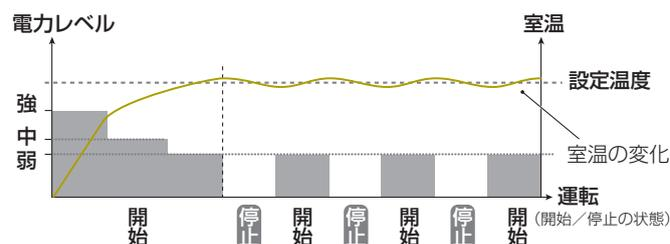
例) 設定温度 25℃、電力レベルの設定を「強」にして、室温 18℃で運転を開始した場合
