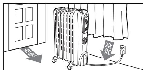
室内で、特に冷気のダウンドラフト（冷気の侵入）が発生しやすい場所＝窓の下や外気に触れている壁際などに設置してください。ヒーターの暖気による「エアカーテン」で、ダウンドラフトの発生を抑えます。また、窓に厚手のカーテンをしたり、ドアの開閉頻度を減らすなどの工夫をすることで、より効果的な暖房が得られます。
