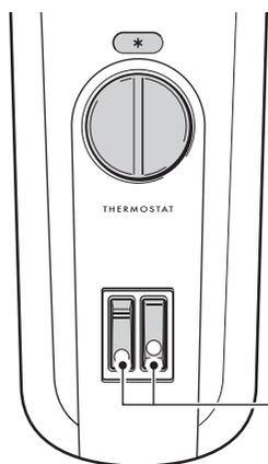
サーモスタットのダイヤルを\*マークに合わせ、電源を入れておくことで、凍結防止機能が働きます。室温が5℃以下になった場合に、室温が約5℃になるようにヒーターが運転を始めます。室内の植物等を凍結から保護するために便利な機能です。
