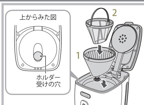
3 ガラスジャグの給水目盛「MAX」まで入れた水を水タンクにそそぎ、空のガラスジャグを保温プレートに載せる
