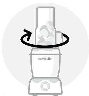
Capovolgere il bicchiere e posizionarlo sulla base motore; ruotare il bicchiere in senso orario per bloccarlo in posizione.
