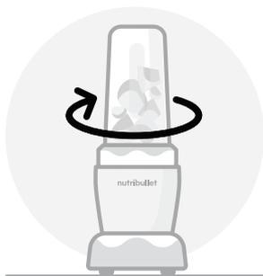
Capovolgere il bicchiere e posizionarlo sulla base motore; ruotare il bicchiere in senso orario per bloccarlo in posizione. Questa operazione aziona il ciclo di miscelazione.
