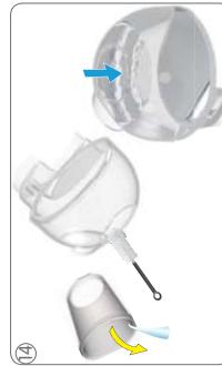
Contentiere vuoto e pulito. Sciacquare e pulire il serbatoio in seguito a riempirlo con acqua potabile fresca e inserirlo nella macchina.
