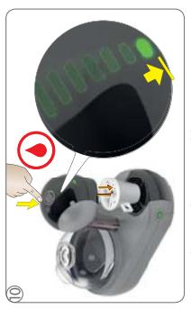
Toccare l'icona di acqua calda (o fredda) a seconda della bevanda. La preparazione della bevanda inizia. Stare accanto alla macchina durante la preparazione. Le barre dello schermo si spengono progressivamente. La macchina interrompe automaticamente la preparazione.
