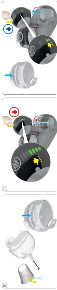
Contentiere vuoto e pulito. Risciacquare e pulire il serbatoio dell'acqua. Utilizzare uno spazzolino pulito adatto ad uso alimentare e un detergente liquido se necessario. Riemarlo in seguito con acqua potabile fresca e inserirlo nella macchina.
