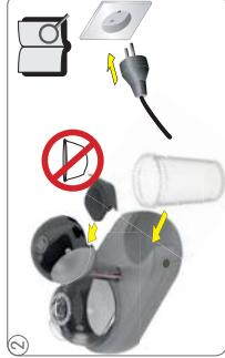
Pulire il serbatoio con acqua potabile fresca. Riempire il serbatoio con acqua potabile fresca. Posizionare il coperchio e inserire il serbatoio dell'acqua nella macchina.
