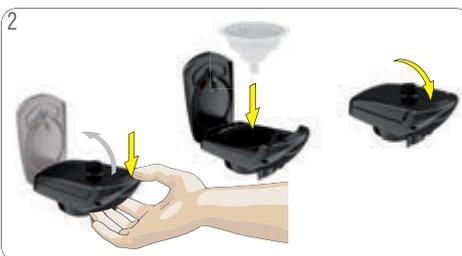
2 Prendere il supporto per capsule e spingere la levetta di blocco per aprirlo. Assicurarsi che l'utensile per il risciacquo sia nel supporto per capsule. Chiudere il supporto per capsule.
