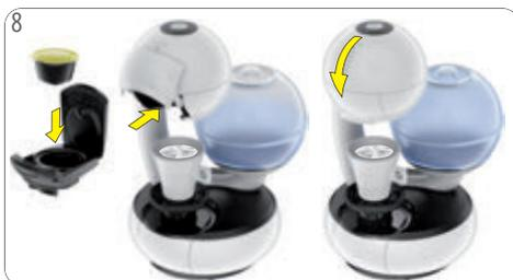
Inserire la seconda capsula nell'apposito supporto. Chiudere il supporto per capsule. Reinserrarlo nella macchina. Chiudere la leva di blocco.
