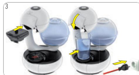
3 Inserire il supporto per capsule nella macchina. Chiudere la leva di blocco. Posizionare un contenitore grande vuoto sotto l'uscita del caffè. Collegare la spina di alimentazione alla presa di alimentazione.
