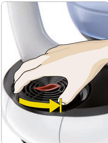
Per regolare la posizione della vaschetta: Ruotare la vaschetta in senso antiorario fino allo sblocco.
