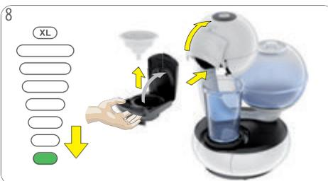
8 Attendere fino a quando il conteggio alla rovescia finisce e la macchina si arresta. Aprire la leva di blocco. Estrarre il supporto per capsule. Aprire il supporto per capsule. Rimuovere l'utensile per il risciacquo. Conservarlo in un luogo sicuro per pulirlo e decalcificarlo in un secondo momento. Reinserire il supporto per capsule.
