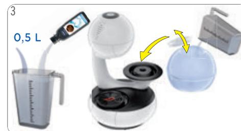
Mescolare 0,5 litro di acqua potabile fresca con il decalcificante in un dosatore. Versare la soluzione decalcificante nel serbatoio dell'acqua e inserirlo nella macchina.
