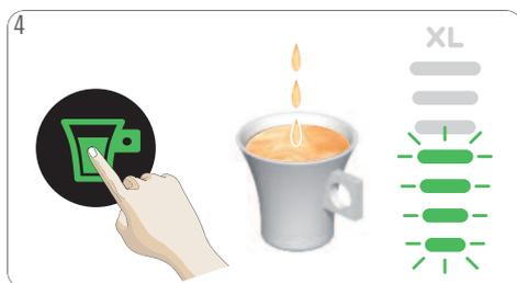
Tocca icona Start/Stop. La preparazione della bevanda inizia. **Non aprire la leva di blocco durante l'estrazione.** Aspettare fino all'arresto dell'estrazione. La macchina interrompe automaticamente la preparazione. L'estrazione può essere interrotta in qualsiasi momento manualmente premendo l'icona start/stop.
