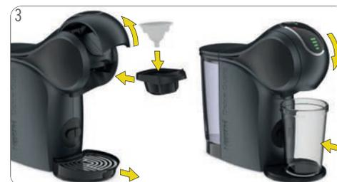
3 Aprire la leva di blocco. Collocare l'utensile per il risciacquo nel supporto per capsule. Inserire il supporto per capsule nella macchina. Chiudere la leva di blocco. Posizionare un contenitore grande vuoto sotto l'uscita del caffè.
