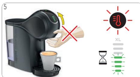
Al termine della preparazione, l'icona di selezione della temperatura e la luce dello schermo a barre lampeggia per un massimo di 8 secondi. **Non aprire la leva di blocco durante questo lasso di tempo!**
