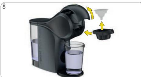
8 Aprire la leva di blocco. Estrarre il supporto per capsule. Rimuovere l'utensile per il risciacquo. Reinsierire il supporto per capsule.
