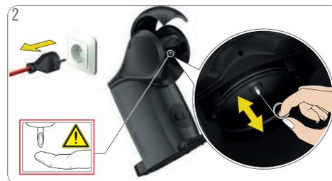
2 Rimuovere il supporto per capsule. Aprire la leva di blocco. Pulire l'iniettore con l'ago di pulizia. Seguire le istruzioni in 9. «Decalcificare almeno ogni 3-4 mesi» a pagina 18.
