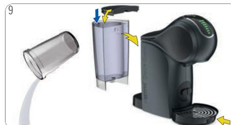
9 Contenitore vuoto. Riempire il serbatoio con acqua potabile fresca. Inserire il serbatoio dell'acqua nella macchina. Reinsierire la vaschetta. La macchina è pronta all'uso.
