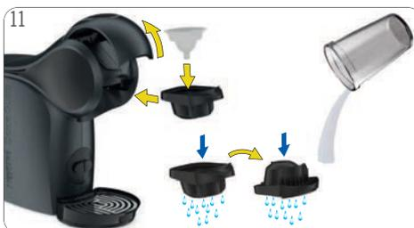
Rimuovere il contenitore. Svuotare il contenitore e pulirlo. Estrarre il supporto per capsule. Rimuovere l'utensile per il risciacquo. Conservarlo in un luogo sicuro per pulirlo e decalcificarlo in un secondo momento. Pulire entrambi i lati del supporto per capsule con acqua potabile fresca. Reinserire il supporto per capsule.
