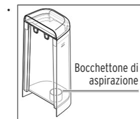
Se il livello di acqua scende al di sotto del bordo superiore del bocchettone di aspirazione, la macchina non riesce più ad aspirare acqua. La pompa continua a funzionare per un paio di secondi in modo più rumoroso e poi si spegne.
