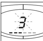
Una volta che il carrello è sceso ha inizio la fase di tostatura (nel display viene visualizzato il numero indicante il livello di tostatura selezionato e i segmenti corrispondenti al tempo selezionato lampeggiano).
