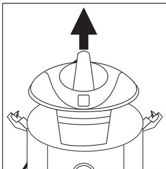
Sollevarre l'unità motore utilizzando l'apposita maniglia, togliere gli accessori dall'interno del fusto e dotare l'apparecchio dei componenti necessari in base al tipo di pulizia da svolgere.
