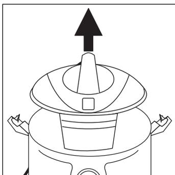
Sollevere l'unità motore utilizzando l'apposita maniglia, togliere gli accessori dall'interno del fusto e dotare l'apparecchio dei componenti necessari in base al tipo di pulizia da svolgere.
