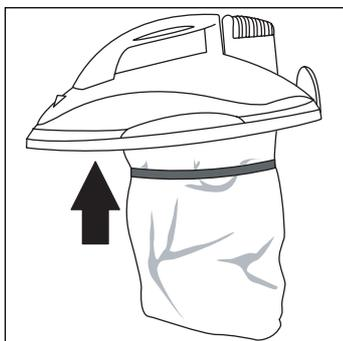
Assicurarsi che il sacco proteggi motore in carta sia infilato sul cestello proteggi motore.
