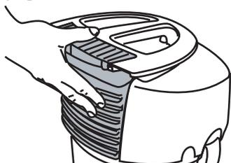
Controllare periodicamente che il galleggiante all'interno del cestello proteggi motore sia libero di muoversi nel suo alloggiamento sollevando la testata dell'apparecchio e scuotendola.
