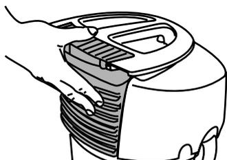
Controllare periodicamente che il galleggiante all'interno del cestello proteggi motore sia libero di muoversi nel suo alloggiamento (fig. 11) sollevando la testata dell'apparecchio e scuotendola.
