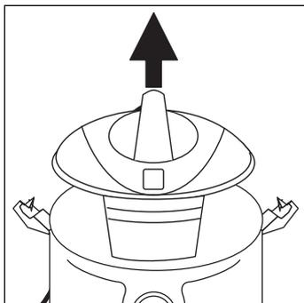
Sollevare l'unità motore utilizzando l'apposita maniglia, togliere gli accessori dall'interno del fusto e dotare l'apparecchio dei componenti necessari in base al tipo di pulizia da svolgere.
