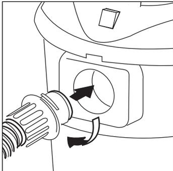
Collegare il tubo flessibile alla bocca di aspirazione dell'apparecchio ruotando il bocchettone del tubo in senso orario fino a quando non risulta ben fissato.
