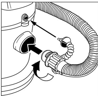
Collegare il tubo flessibile alla bocca di aspirazione dell'apparecchio ruotando il bocchettone del tubo in senso orario fino a quando non risulta ben fissato. Innestare il tubetto di erogazione liquidi (10) (anche se non necessario per la funzione aspirapolvere) questo per evitare che sia di disturbo durante la pulizia. Applicare i tubi di prolunga all'impugnatura e all'altra estremità l'accessorio di pulizia adatto al tipo di operazione da svolgere.
