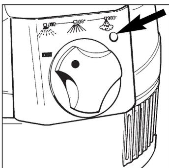
Ruotare il selettore tipo di lavaggio (6) dalla posizione di OFF a JET e automaticamente si accenderà una spia luminosa che indica che l'apparecchio è pronto per il lavaggio ad estrazione.
