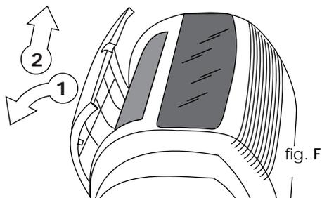
Per togliere la polvere depositata sul filtro usare un aspirapolvere. Se è molto sporco immergetelo in acqua tiepida risciacquando più volte. La temperatura dell'acqua va mantenuta sotto i 40° C.
