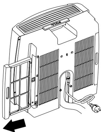
Per togliere la polvere depositata sul filtro usare un aspirapolvere. Se sono molto sporchi immergeteli in acqua tiepida risciacquando- li più volte. La temperatura dell'acqua va mantenuta sotto i 40° C.
