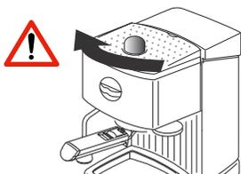
– Prima di accendere la macchina accertarsi che la **manopola di regolazione vapore-acqua calda sia spenta** (ruotare in senso orario verso il «←»), acqua calda o vapore potrebbero altrimenti fuoriuscire dall'erogatore
