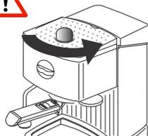
... aprire immediatamente la manopola **di regolazione vapore-acqua calda** (più si gira la manopola in senso antiorario, più acqua verrà erogata)
