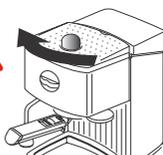
Chiudere la manopola di regolazione vapore-acqua calda
