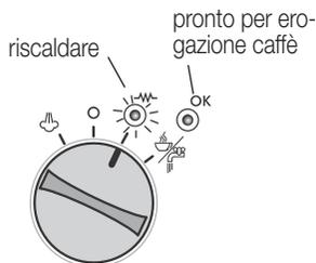
– Girare verso destra l'interruttore principale sulla posizione «riscaldamento/in preparazione» -W- .
