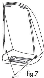
Fissare il tutto con le due viti precedentemente rimosse (fig.7). Inserire la bombola nel vano.
