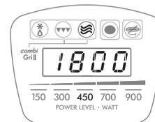
selezionare il livello di potenza delle microonde premendo ripetutamente il tasto **POWER LEVEL** (3) fino a far lampeggiare la potenza desiderata espressa in numeri sotto il display. Per la scelta della potenza, consultare sempre le tabelle riportate al Capitolo 4.
