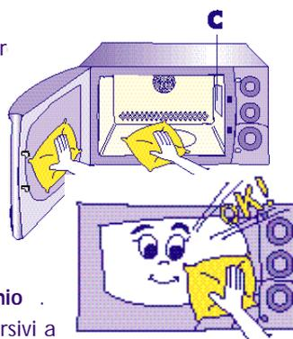
Pulire regolarmente i fori d'ingresso aria posti sul retro del forno in modo che con il tempo non vengano ostruiti da polvere e deposito di sporco.
