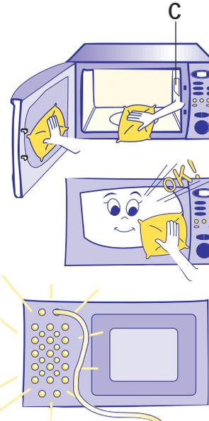
Pulire regolarmente i fori d'ingresso aria posti sul retro del forno in modo che con il tempo non vengano ostruiti da polvere e deposito di sporco.
