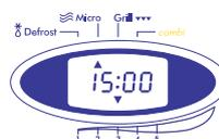
5. Al termine del tempo impostato il controllo emette tre beep lunghi mentre sul display appare la scritta **"End"**.
