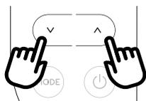
È possibile visualizzare la temperatura in °C o °F. Per cambiare l'unità di misura della temperatura, tenere premuti o premere separatamente i tasti di aumento ^ (C4) e diminuzione v (C3) per circa 10 secondi.
