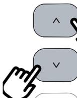
La temperatura può essere visualizzata in °C o °F. Per modificare l'unità di misura della temperatura, toccare contemporaneamente per dieci secondi i tasti di aumento  $\wedge$  (C3) e diminuzione  $\vee$  (C4).
