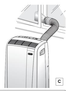
Limitare al minimo possibile la lunghezza e le curve del tubo aria evitando qualunque strozzatura.
