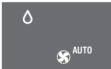
È ideale per ridurre l'umidità degli ambienti (stagioni intermedie, locali umidi, periodi di pioggia, ecc.). Per questo tipo di utilizzo, l'apparecchio deve essere predisposto nello stesso modo previsto per la modalità condizionamento, ovvero con il tubo scarico aria (B2) applicato all'apparecchio per permettere lo scarico dell'umidità all'esterno.
