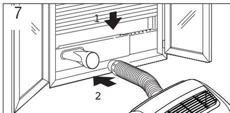
**i** Limitare il più possibile la lunghezza e le curve del tubo aria evitando qualunque strozzatura.
