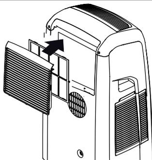
Alcuni modelli, nella griglia posteriore prevedono l'utilizzo di un filtro antipolvere a ioni d'argento e di un filtro supplementare elettrostatico.
