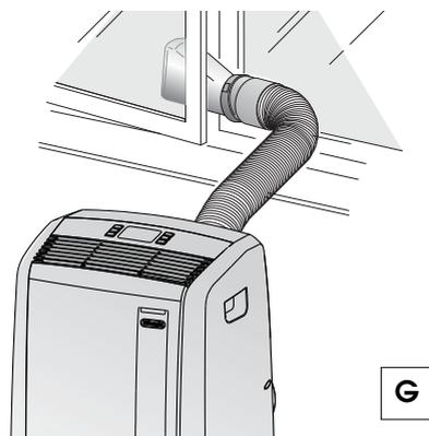
Limitare al minimo possibile la lunghezza e le curve dei tubi aria evitando qualunque strozzatura.
