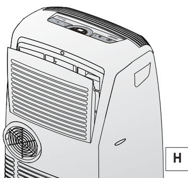
Per togliere la polvere depositata sul filtro usare un aspirapolvere. Se è molto sporco immergerlo in acqua tiepida risciacquando più volte. La temperatura dell'acqua va mantenuta sotto i 40° C.
