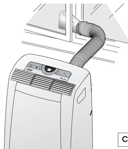
Limitare al minimo possibile la lunghezza e le curve dei tubi aria evitando qualunque strozzatura.
