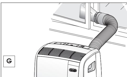
Limitare al minimo possibile la lunghezza e le curve dei tubi aria evitando qualunque strozzatura.
