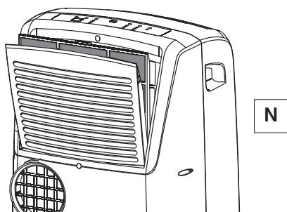
Per togliere la polvere depositata sul filtro usare un aspirapolvere. Se è molto sporco immergerlo in acqua tiepida risciacquarlo più volte. La temperatura dell'acqua va mantenuta sotto i 40° C.
