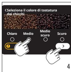
4. Controllare sulla confezione del caffè il livello di tostatura: è anche possibile confrontare il caffè con la guida sul display. Premere >.
