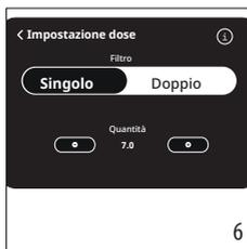
6. Scegliere il filtro che si sta utilizzando (singolo: 1 tazza; doppio: 2 tazze). È possibile regolare il tempo di macinatura premendo il pulsante ⊖ o ⊕ (il tempo aumenta o diminuisce di 0,5 secondi alla volta).
