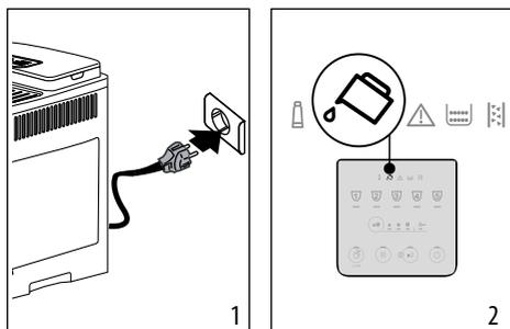
2. Sul pannello di controllo (B) si accende la spia
