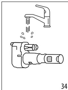
7. Risciacquare accuratamente il connettore caraffa latte (E6) (fig. 34). Prestare particolare attenzione che sul canalino aria (nell'ingrandimento) (fig. 35) non rimangano residui di latte: eventualmente rimuoverli con uno stuzzicadenti;
