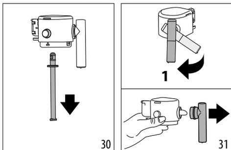
4. Ruotare il tubo erogazione latte in posizione verticale e tirare fino ad estrarlo (fig. 31).
