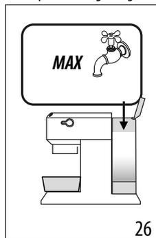
8. La macchina è pronta per il risciacquo con acqua fresca e pulita. Estrarre il serbatoio acqua, svuotarlo, risciacquarlo con acqua corrente, riempirlo fino al livello MAX con acqua fresca (fig. 26) e reinserrirlo in macchina.
