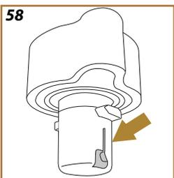
6. Assicurarsi non ci siano residui di latte nei nella cavità e scanalatura nella parte inferiore della manopola (fig. 58). Se necessario, raschiare con uno stuzzicadenti;
