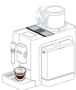
*Si tratta di vapore sprigionato dalla dose caffè utilizzata e smaltita automaticamente nel contenitore fondi della macchina. Fa parte del normale e corretto funzionamento della macchina.*
